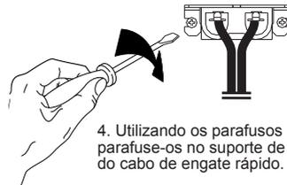
4. Utilizando os parafusos removidos, parafuse-os no suporte de fixação do cabo de engate rápido.
