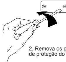
2. Remova os parafusos da tampa de proteção do conector do nobreak.
