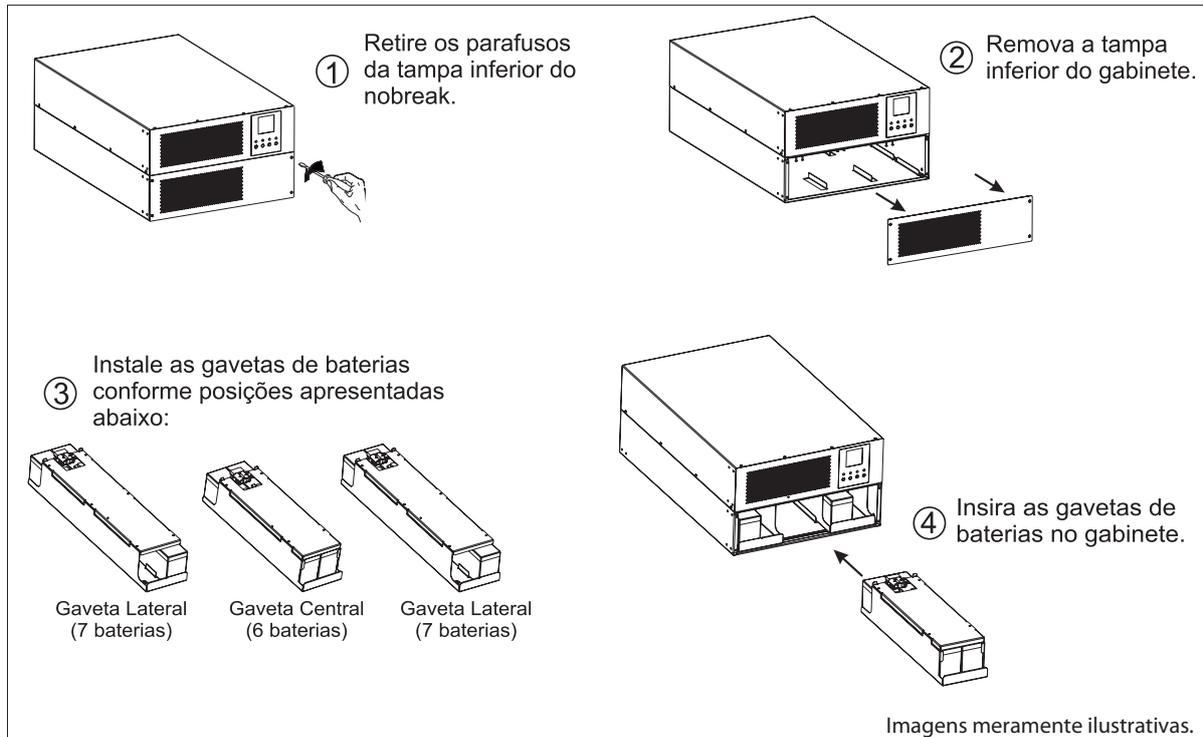
**Obs.:** Ao concluir a instalação das gavetas de baterias, fixe a tampa inferior ao gabinete com os parafusos removidos.
