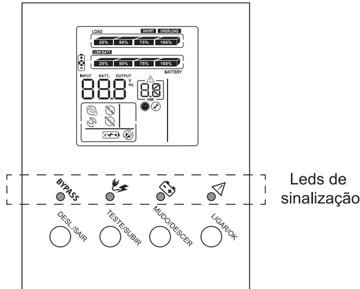
Há 4 LEDs no painel frontal que mostram o funcionamento do nobreak, conforme tabela abaixo:
