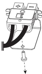
2. Remova os parafusos da tampa de proteção do conector do nobreak.
