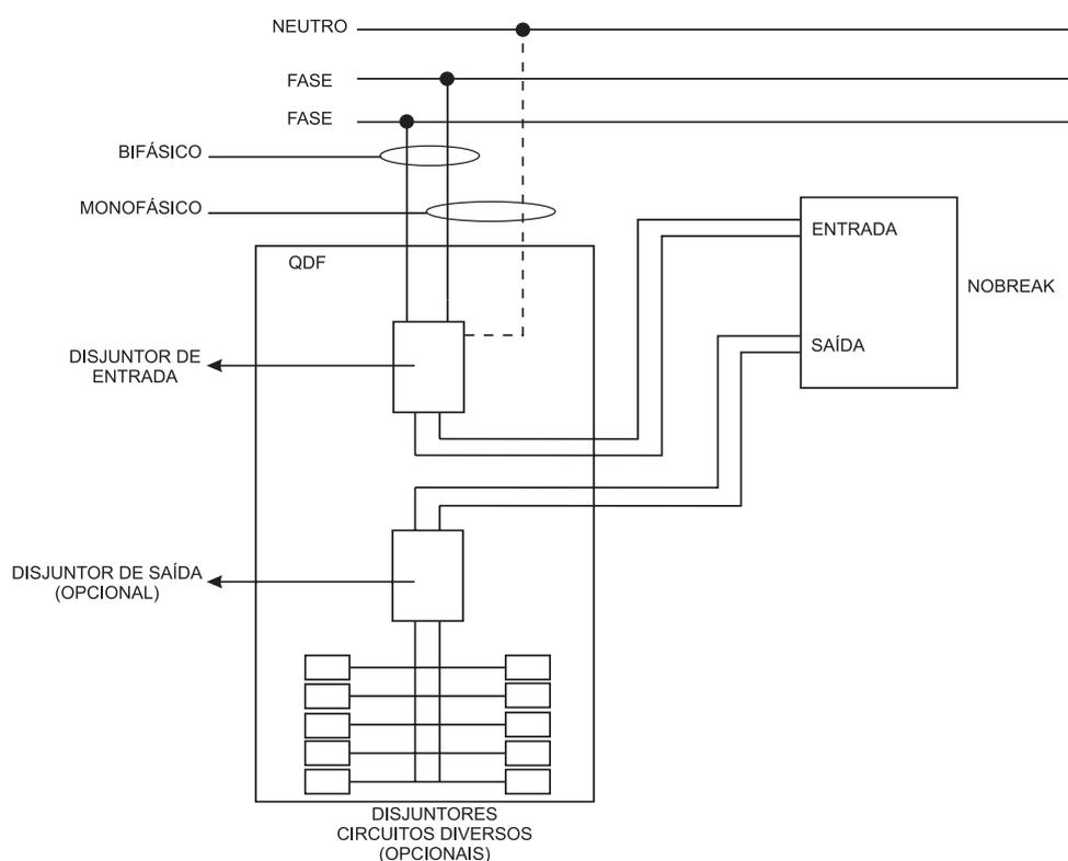
**Obs.:** O nobreak poderá ser alimentado por um sistema monofásico ou bifásico, sendo necessário apenas que a tensão da rede seja 220V~.
